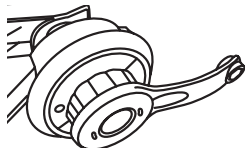
Рис. 14. Откручивание головки при помощи ключа
