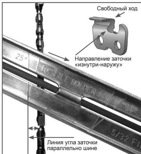
Рис. 16 Определение угла заточки
