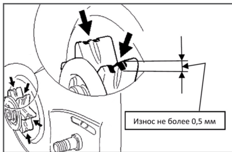
Рис. 14 Проверка износа звездочки
