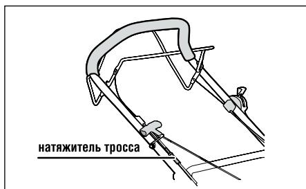
▶ вращением втулки по/против часовой стрелки обеспечьте рабочий ход рычага, согласно указанному требованию;
