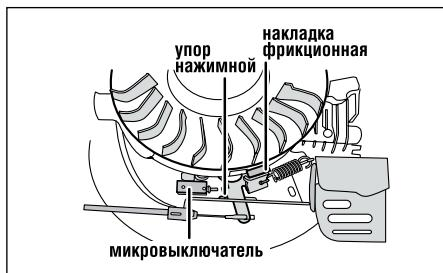
▶ проверьте рабочий ход рычага тормоза (от момента касания упором штока до выбора хода рычага тормоза). Рабочий ход должен составлять 40–60 мм. В противном случае, отрегулируйте ход рычага на соответствие указанному требованию, для чего:
