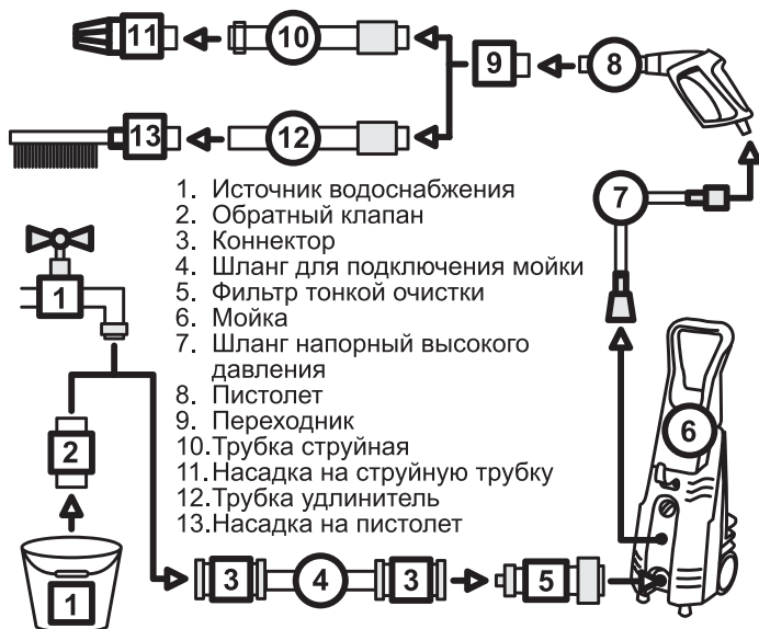
Рис. 13 Схема подключения аппарата с дополнительным оборудованием
