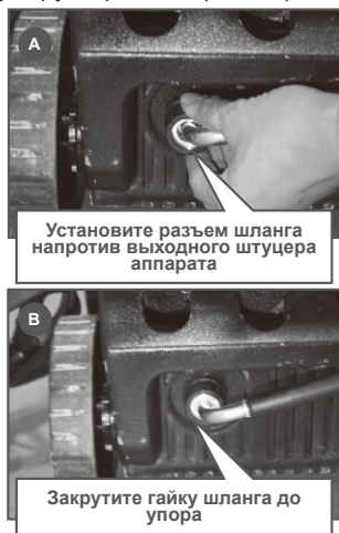
Рис. 4 Подключение шланга высокого давления к аппарату
